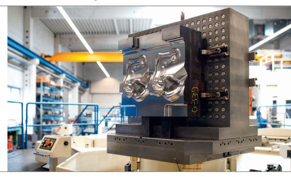
**präzise Massivumformung:** Je besser die Oberflächen der Gesenke, desto besser
