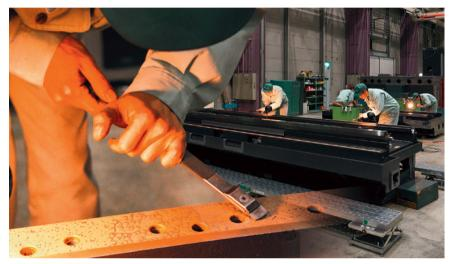
**Eine Besonderheit bei Yasda:** Um eine möglichst dauerhaft hohe Präzision in der Bearbeitung sicherzustellen, werden die Führungen handgeschabt. Diese zeitintensive Technik ermöglicht es, eine Ebenheit der Flächen zu schaffen, die maschinell so nicht erzeugt werden kann; eine der Folgen ist eine Positionsunsicherheit von maximal 3 μm in allen Linearachsen. © Technoteam
